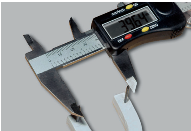
Abb. 9 Zur Ermittlung der transversalen und saggitalen Veränderung wurde aus einem Klasse IV Gips ein Prüfkörper in einer U-Form erstellt, die in etwa einem Zahnbogen entspricht. In diesen Prüfkörper wurden in der Mitte und an den Enden Stifte angebracht. Diese U-Form wurde auf ihre Strecken hin vermessen.
